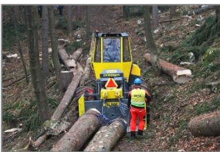
Hier handelt es sich um einen auch autonom fahrenden Spezial-Forstschlepper mit Knicklenkung, der mit einem stufenlos und elektronisch gesteuerten hydrostatischen Fahrtrieb von Sauer Bibus ausgestattet wurde.
