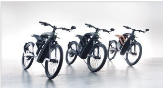
FEDDZ ist ein Elektro-Kleinkraftrad mit bürstenlosem Hinterradnaben-Elektromotor.
